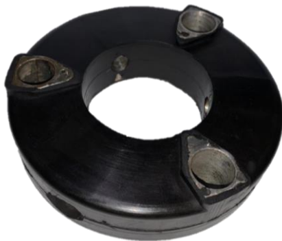
Diámetro exterior 6 3/4" Diámetro interior 3 1/4", Altura 1 1/2"
