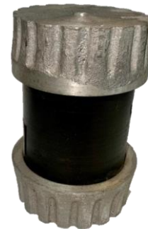
Soporte para criba vibratoria completa con 2 tapas de aluminio. Altura 4 ¼ , diámetro exterior 2" ½ y ½ hexagonal
