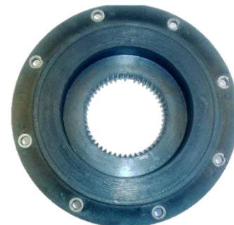
Lámina de 12 ¼" de diámetro y baquelita dentada 8" diámetro exterior baquelita interior 4"
